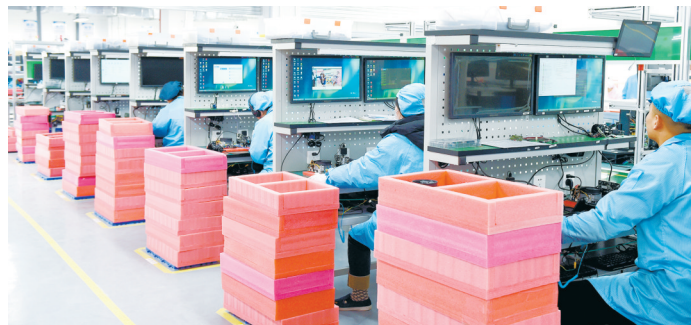
卓怡恒通信息安全有限公司测试车间内，工人们正在进行电脑主板测试工作。
