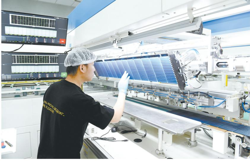
5月6日，山西瑞安太阳能科技有限责任公司生产车间内，工作人员正在层层检查自动化串焊太阳能电池片。该公司位于漳泽新型工业园区，是一家国家级高新技术企业，公司目前拥有光伏一体化产能7GW，产品远销国内外。
