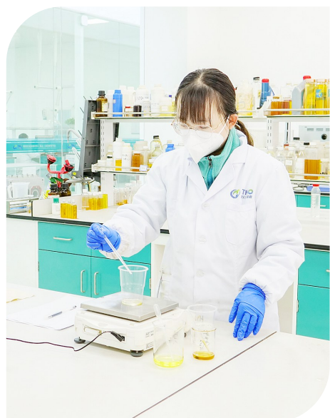
太行润滑科技有限公司技术员对高黏附开式齿轮润滑剂质量进行检测。
