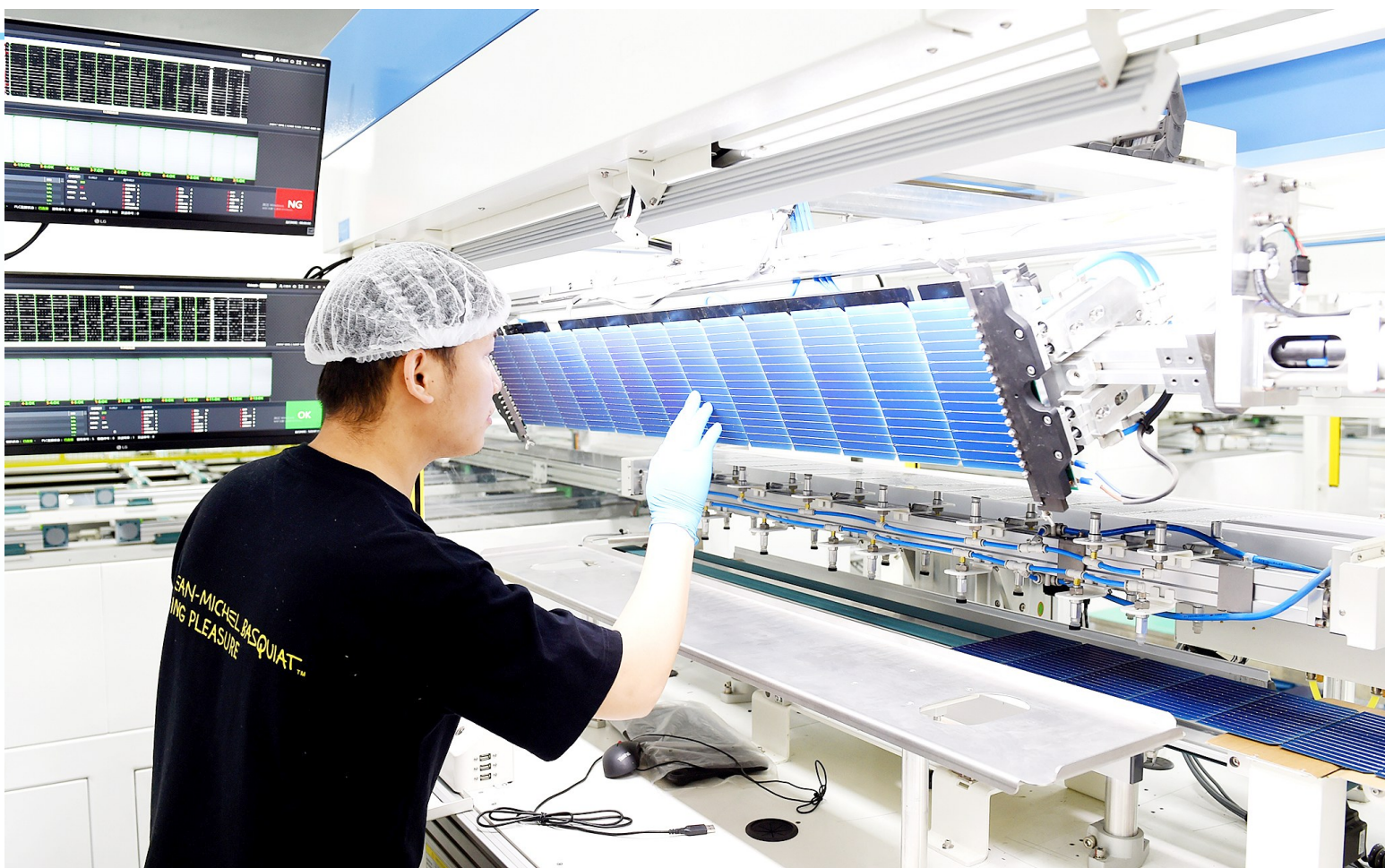
潞安太阳能公司工人正在进行串检作业。
