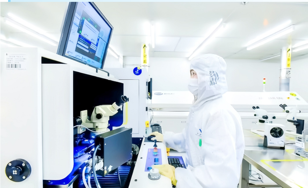
中科路安紫外光电科技有限公司,技术员在点测机前测试芯片光电性能。
