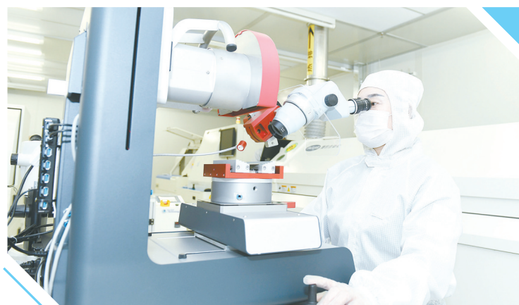
中科潞安紫外LED器件推拉测试。
