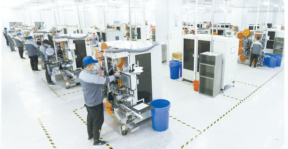
电子高端电容新材料科技产业园内，技术员正在机器前进行卷绕工艺操作
