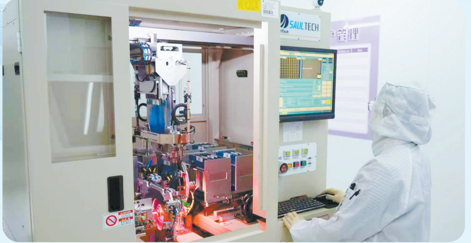
中科瑞安紫外光电科技有限公司技术人员在点测机前测试芯片光电性能
