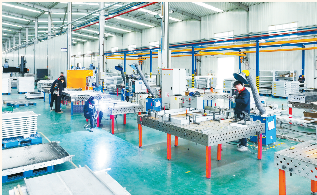
2月15日，山西中德集团新能源汽车生产车间内，工人正在焊接汽车零部件。近年来，该集团引进国内领先的铝镁合金焊接技术，可参与整车研发、试制等全流程的制造，给整车厂商提供系统优化方案。本报记者 张国平 摄
