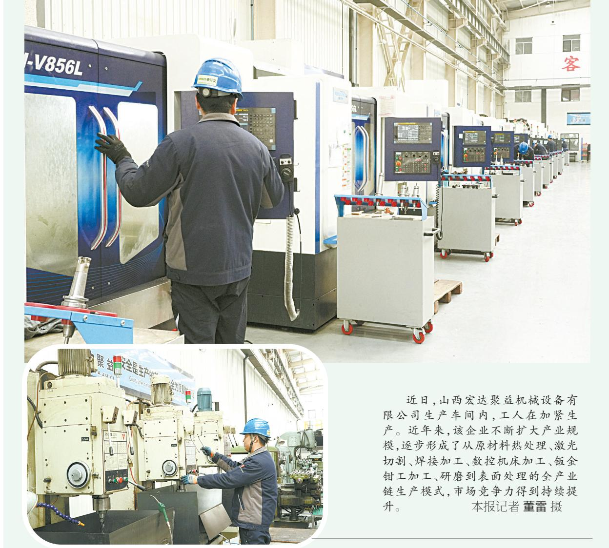
近日,山西宏达聚益机械设备有限公司生产车间内,工人在加紧生产。近年来,该企业不断扩大产业规模,逐步形成了从原材料热处理、激光切割、焊接加工、数控机床加工、钣金加工,研磨到表面处理的全产业链生产模式,市场竞争力得到持续提升。
