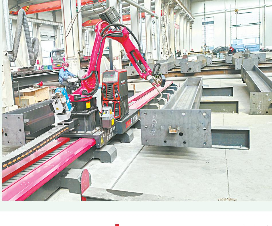
3月24日，长治市荣科钢结构工程有限公司的智能焊接机器人正在焊接作业。为提升生产线智能化水平，该公司新引入的智能机器人系统，较传统人工焊接效率提升约30%，有效缓解人力短缺问题，降低综合成本。
