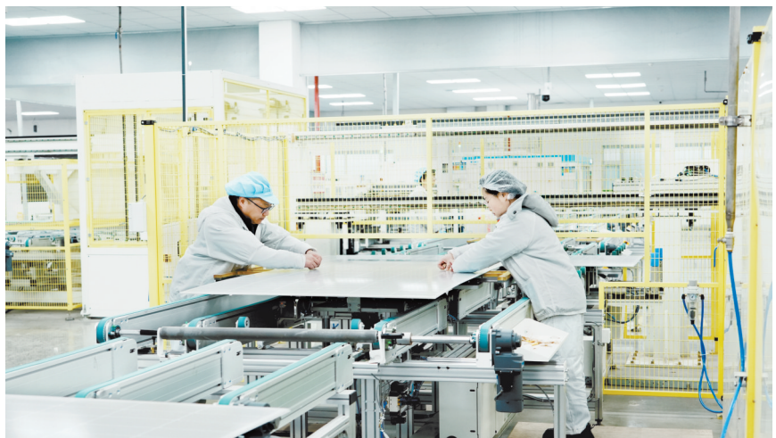
2月9日,在山西潞安太阳能科技有限责任公司生产车间内,工作人员正在检查自动化串焊太阳能电池片。该公司目前拥有光伏一体化产能7GW,产品覆盖全尺寸P/N型高效电池、组件,能满足全场景光伏发电应用领域需求。
