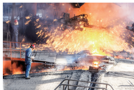
高炉正在出铁。(摄于2012年)
