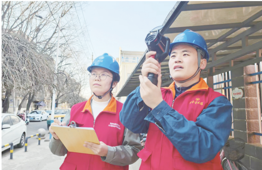
暴显明(左)和同事对架空线路进行红外测温。
