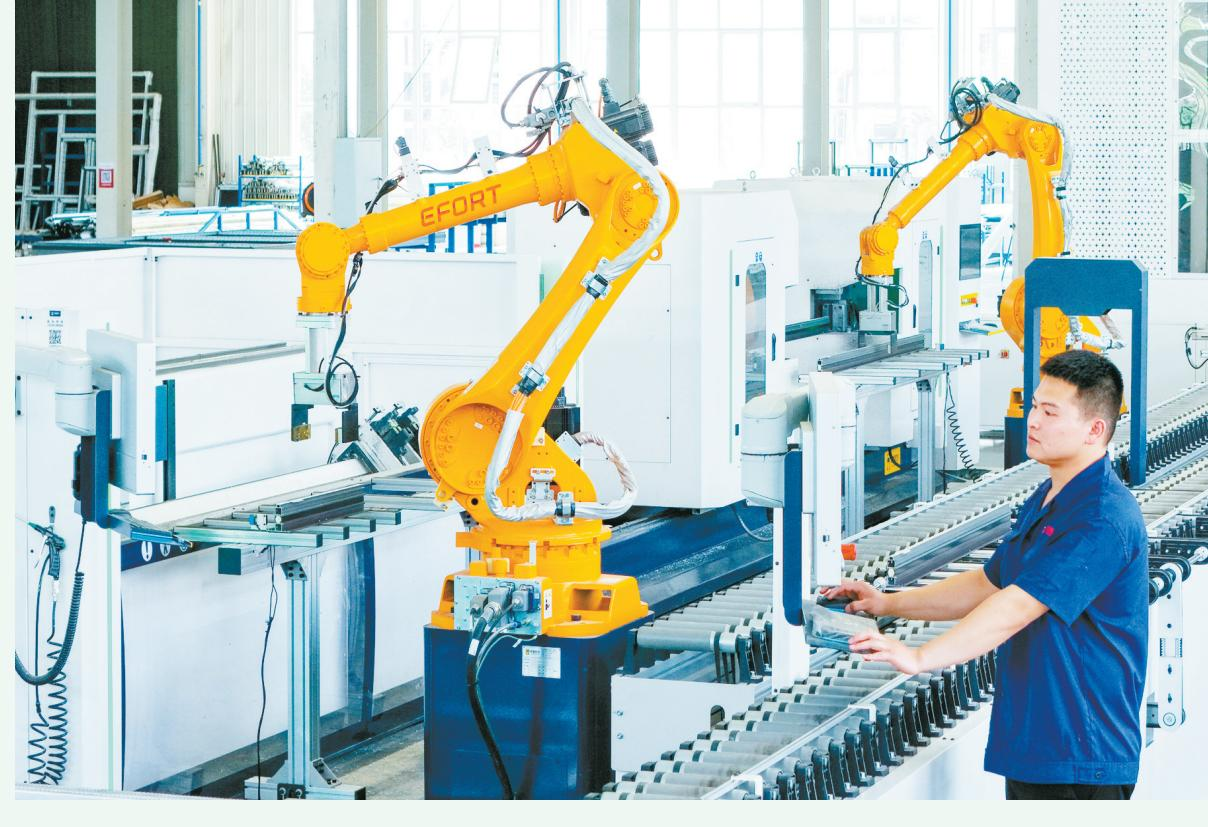
6月17日,长治经开区中德集团中德家系统门窗全自动化车间内,员工正在操作智能设备。近年来,中德集团瞄准“智造”转型,大力引进雷德数控智能激光锯铣系统,集数字化生产于一体,从源头保障产品品质,以科技赋能品牌,提升产品竞争力。
