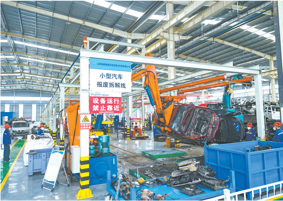
11月11日，山西瑞赛格废弃资源综合利用有限公司生产车间内，机械臂在翻转报废车辆，小型汽车报废拆解线正高效运转。近年来，该公司立足打造华北地区规模最大、装备最全、标准最高的废钢加工配送基地，目前已具备年拆解3.5万辆报废汽车能力，被工信部认定为废钢加工准入企业、国家级绿色工厂。
