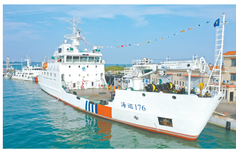
11月13日，由我国自主设计建造的2000吨级大型航标船“海巡176”轮正式列编交通运输部南海航海保障中心。 据了解，“海巡176”轮总长75.2米，型宽14米，满载排水量2360吨，是目前全国交通运输系统最大最先进的航标作业船。该船列编后将承担南海海区航标布设、维护任务，为我国在南海的海洋资源开发、科研考察、海上执法等活动提供可靠的航海保障。 新华社记者 郭程 摄
