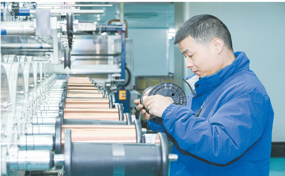
12月24日，山西路鸿智能科技有限公司的漆包线生产车间，工作人员正在进行换盘作业。
